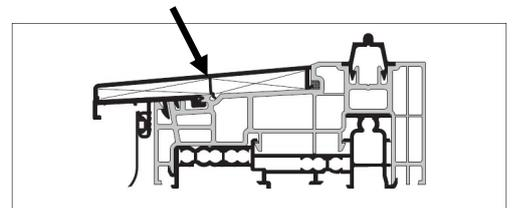
Einbaubeispiel GU-thermostep mit Laufschiene 15 P 1635 und COMFORT-Profil P 01767
